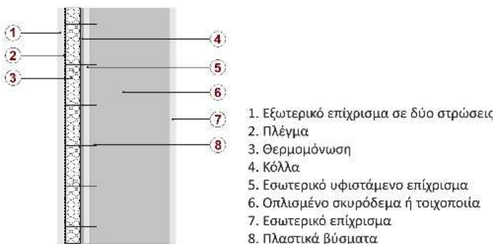
Εικόνα 1: Ενδεικτική τομή εξωτερικής θερμομόνωσης
